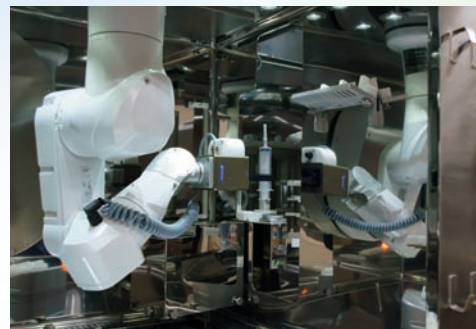
西日本初の「抗がん剤自動調整装置」(東棟2階)
